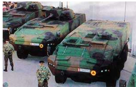
Силы обороны Финляндии проводят ходовые испытания трех AMV (бронированных модульных машин) производства фирмы Patria с колесной формулой 8x8.
