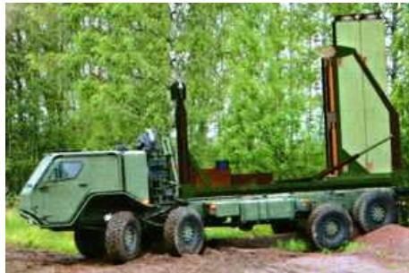
Фирма Denel Dynamics разработала наземную ракетную установку с шестью ракетами, разработанную для ракетной системы Umkhonto вертикального пуска класса земля-воздух.
