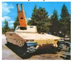
Спаренный вариант минометной системы огневой поддержки (AMOS) не оправдал всех надежд, связанных с коммерческой реализацией. Система разработана фирмами Patria Land & Armament (Финляндия) и BAE Systems Hagglunds. Финляндия заказала 24 башни с минометными установками и они установлены на шасси бронетранспортера AMV фирмы Patria.
