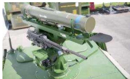
Французские фирмы MBDA, Panhard и Sagem на базе дистанционно управляемого боевого модуля WASP создали новый, который может пускать противотанковые ракеты средней дальности MILAN ER.
