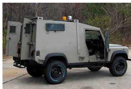
David — легкая бронированная машина, созданная на базе машины Land Rover Defender, предназначенной для перемещения по труднопроходимым участкам местности. Машина David была выбрана IDF (израильские силы обороны) в качестве стандартной машины, предназначенной для разведки и патрулирования. Сотни таких машин уже были изготовлены.
