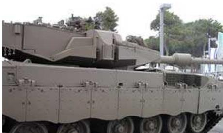
Танковая система активной защиты (ADS) Aspro-A (известная также под наименованием Trophy), разработанная компанией Rafael, проходит эксплуатационные испытания на танке Merkava Mk4 в Израиле.
