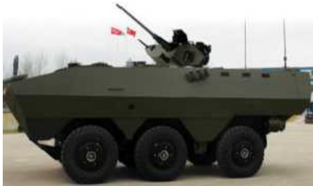
Турецкая компания Nurol Makina ve Sanayi AS начала испытания серии новых модификаций недавно разработанных колесных бронетранспортеров Ejder (Дракон) с колесной формулой 6х6.
