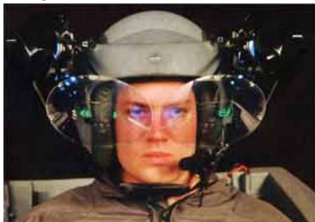
Вторым типом тренажеров, продемонстрированным на I/ITEC 2004 фирмой L-3 Link Simulation and Training был авиационный тренажер на основе Встроенного в шлем дисплея (Advanced Helmet Mounted Display – AHMD).
