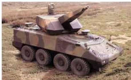
Одна из нескольких показанных в этом году на выставке IDEX мобильных систем ПВО – швейцарская артиллерийская система Skyranger фирмы Oerlikon Contraves, установленная на шасси Piranha 8x8 фирмы MOWAG.
