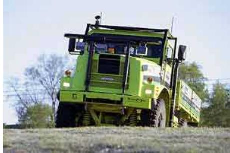
Одновременно Пармский Университет ведет разработку системы наблюдения в разных направлениях (MDV-VS). Фирма Ibeo Automobile Sensor поставляет специализированную систему LIDAR, в которой применены ее датчики XT Alasca, Аубурнский Университет занимается внедрением комплекта GPS/IMU и оказывает помощь в вопросах управления машиной.
