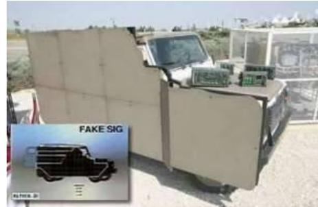
По словам Меира, компания также испытала еще одну функцию системы - ее способность к изменению сигнатуры в тепловом диапазоне, меняя вид одной машины на другой. Эта функция позволяет танк, оборудованный Black-Fox, выглядеть как грузовик, джип, а бронетранспортеру, машине ПВО или ракетной пусковой установке выглядеть как обычный грузовик. Эти функции позволят сидеть с толку разведку врага, заставив его считать такие цели объектами низкого приоритета.
