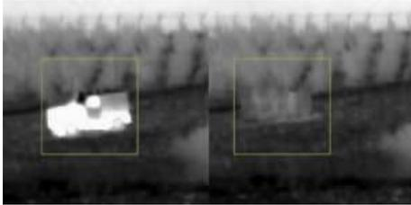
Израильская компания Eltics, которая занимается исследованиями в области технологий стелс в тепловом диапазоне, обнародовала короткое видео с изображением результатов последних испытаний, где большие тепловые панели, установленные на машине Land Rover Defender, смогли скрыть сигнатуру, полностью замаскировав машину на экране тепловизионного прицела.
