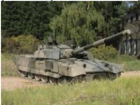
На сегодня комплекс «Реликт» не имеет аналогов ни за рубежом, ни в России. Он может устанавливаться на любые танки, как новые, так и находящиеся в эксплуатации, повышая их противокумулятивную стойкость минимум в 2 раза, противоснарядную - в полтора раза. Масса комплекса 2,5 тонны.
