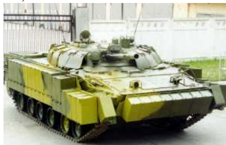
Рис.4. ДЗ первого поколения на БМП-3, разработка НИИ Стали, 1999 г.
