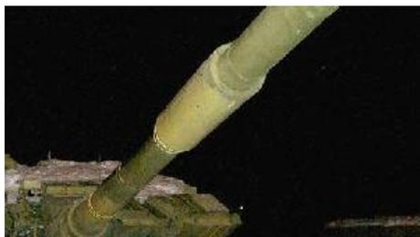
Эжектор пушки — устройство продувки ствола артиллерийского орудия от пороховых газов и уменьшения загазованности боевых отделений танков и самоходных артиллерийских установок.
